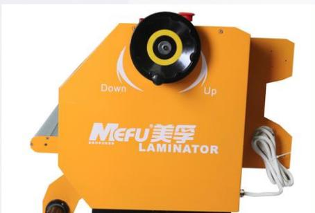
4. Поднимите вал, повернув колесо по часовой стрелке.
