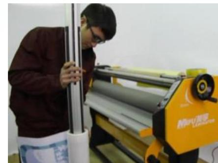
3. Разместите рулон прозрачной самоклеящейся пленки и пустую гильзу (для намотки подложки) на верхних валах, ламинируемый материал и пустую гильзу (для намотки готового изделия) на нижних валах и выровняйте их друг относительно друга используя линейки на валах.
