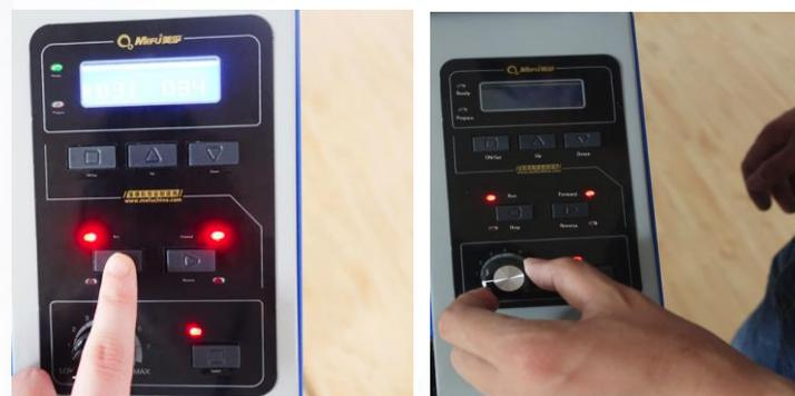
10. В прямом режиме нажмите «Run» для ламинирования. Регулятором установите нужную скорость.
