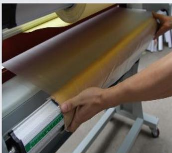
5. Протяните пленку под рабочим валом и закрепите на гильзе для намотки готового изделия, как показано на фото.
