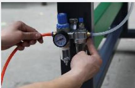
4. Подключите трубку (от компрессора) к воздушному входу водно-масляного сепаратора.
