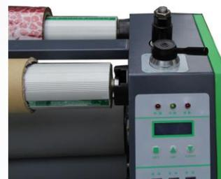
14. Поверните ручку направо для опускания вала, затем верните в среднее положение.
