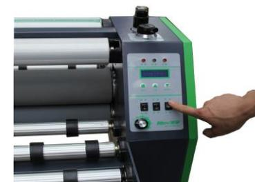
15. Включив переключатель Hot/Cold подогрейте рабочий вал. Нажав кнопку SET установите температуру нагрева (40-50°C для холодного ламинирования, 90-100°C для горячего ламинирования).
