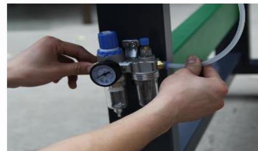
3. Подключите трубку (от компрессора) к воздушному входу водно-масляного сепаратора.
