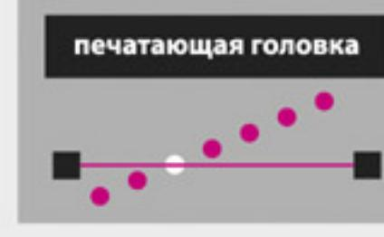
Поток чернил определяется как дефектный в случае фиксации светового луча специальным датчиком.
