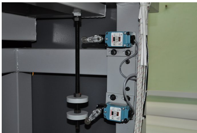
Рис. А Концевые переключатели плиты пресса. В исходном положении верхний переключатель должен быть в состоянии ON, нижний— OFF.
