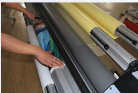
14. Опустите прижимной вал чтобы зафиксировать отпечаток.
