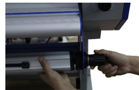
16. Отрегулируйте натяжение в зависимости от материала.
