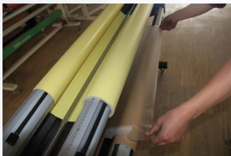
12. Протяните плёнку и закрепите на гильзе.
