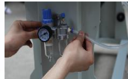
3. Подключите трубку (от ламинатора) к воздушному выходу водно-масляного сепаратора.
