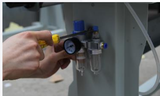
2. Установите водно-масляный сепаратор
