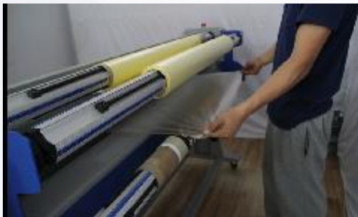
12. Протяните плёнку и закрепите на гильзе.
