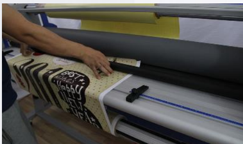
14. Опустите прижимной вал чтобы зафиксировать отпечаток.
