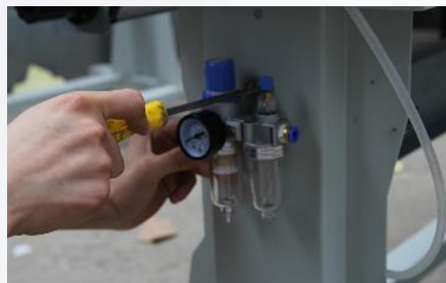
2. Установите водно-масляный сепаратор
