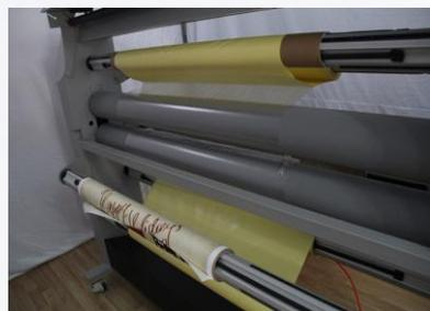
11. Протяните пленку под рабочим валом и закрепите на гильзе для намотки готового изделия, как показано на фото.
