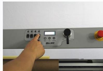
20. Включив переключатель Hot/Cold подогрейте рабочий вал. Нажав кнопку SET установите температуру нагрева (40-50°C для холодного
