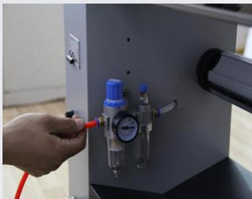
1. Подключите трубку (от компрессора) к воздушному входу водно-масляного сепаратора.
