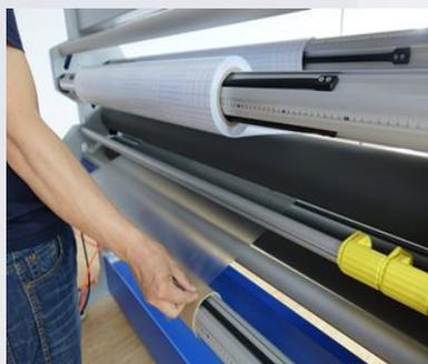
9. Протяните пленку под рабочим валом и закрепите на гильзе для намотки готового изделия, как показано на фото.
